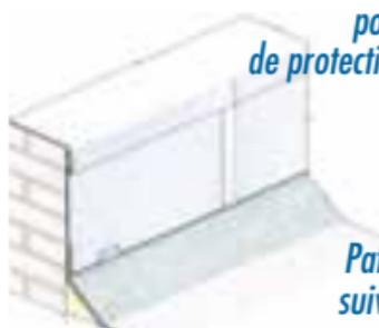
Utiliser un parement séparé pour une retombée supérieure à 150 mm
