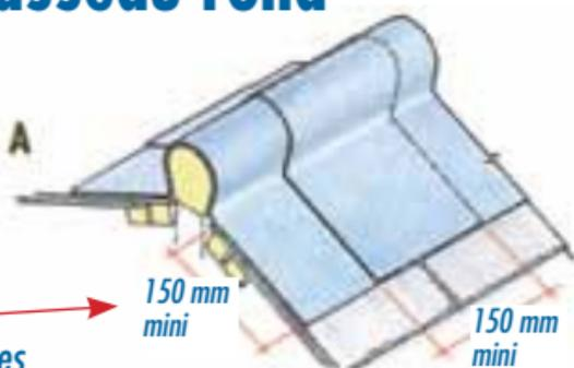
*Fixation sur le dessus de chaque pièce de raccordement de l'arêtier.*
